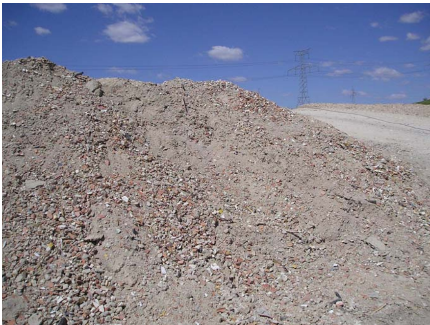
■ Imagen 4. Producto final del triturado de escombros.
