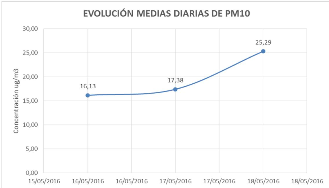
Durante las 12:00- 13:00 horas del día 18/05 se ha observado un pico el registro de PM10 de 49  $\mu\text{g}/\text{m}^3$ , llegando casi hasta el VL diario de 50  $\mu\text{g}/\text{m}^3$ . La velocidad del viento era de 1,6 m/s (suave) y en dirección 248º, es decir, WSW.
