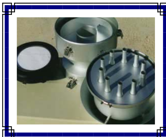
Cabezal PM 10 desmontado sobre un equipo CAV
