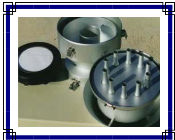
Cabezal PM10 desmontado sobre un equipo CAV
