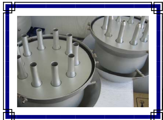
Cabezales PM 10 y PM 2,5 desmontados para su limpieza.
