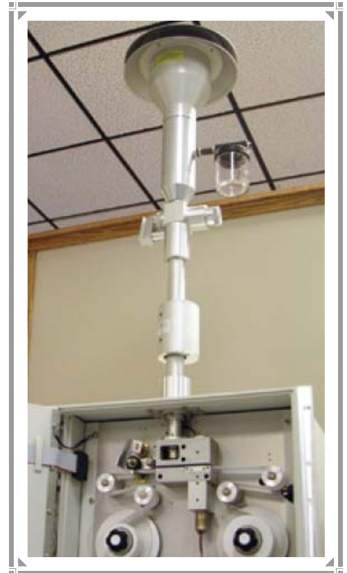
Equipo de radiación beta para la determinación en continuo de PM10 / PM2,5
